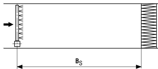
Billede 33: Montering i luftkanal/luftbehandlingsenhed. Nedstrømsforhindring: Svævestof-filter
